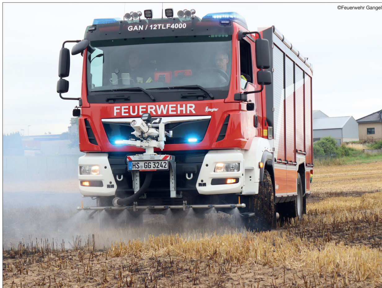
Tanklöschfahrzeug 4000 (Fassungsvermögen: 6.000 Liter Löschwasser)
